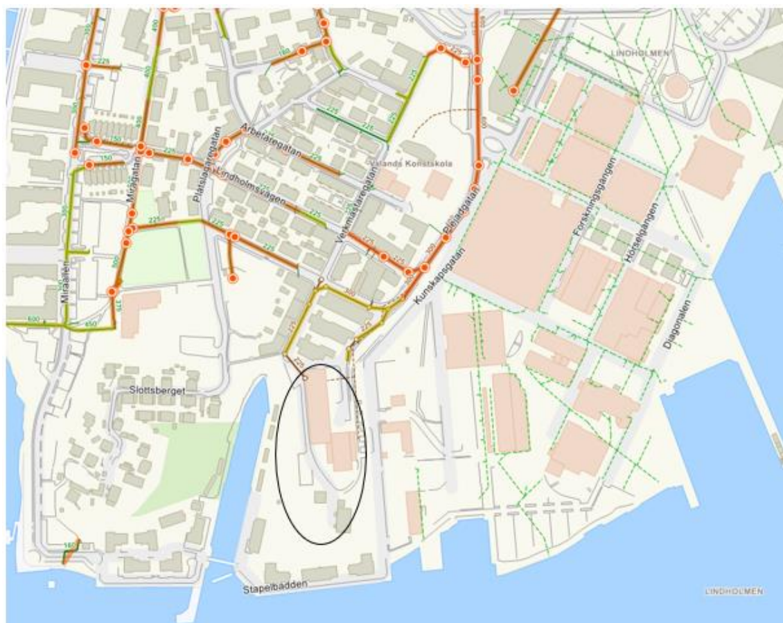
Figur 8. Kapacitet i separerat och kombinerat ledningsnät nedströms planområdet vid ett dimensionerat 10-årsregn. Röd punkt indikerar vattennivå ovan mark vid brunn. Röd linje indikerar vattennivå ovan marknivå och gul linje indikerar vattennivå ovan hjässa i ledning. Planområdet översiktligt markerat i svart. Beräknat enligt Kretslopp och vattens hydrauliska modell.
